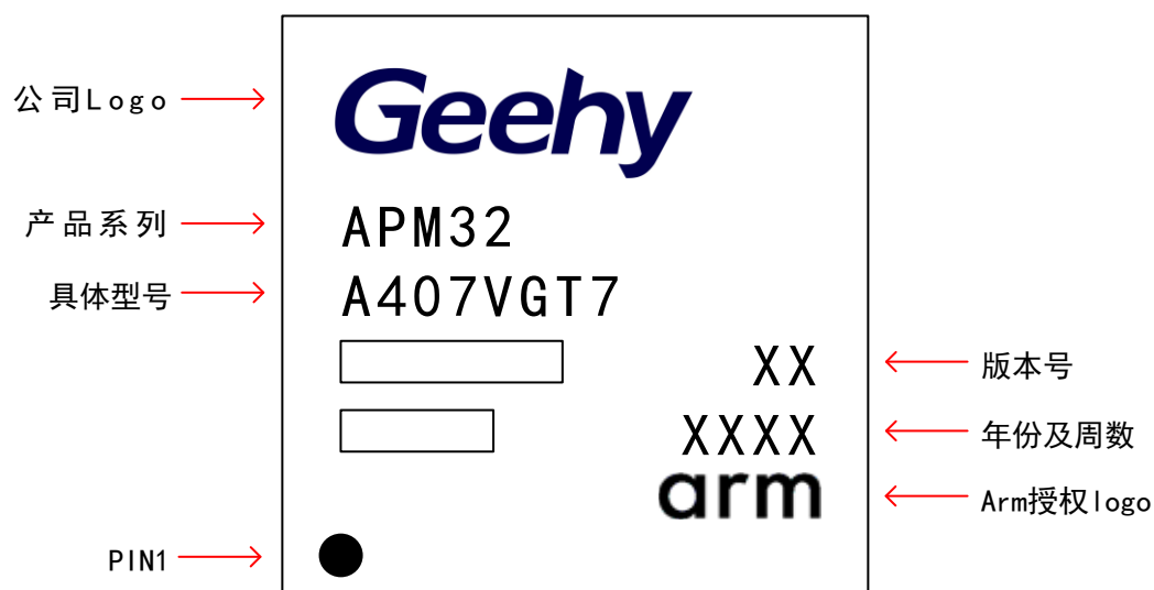
图 19 LQFP100 – 100 引脚，14 x 14mm 示意图
