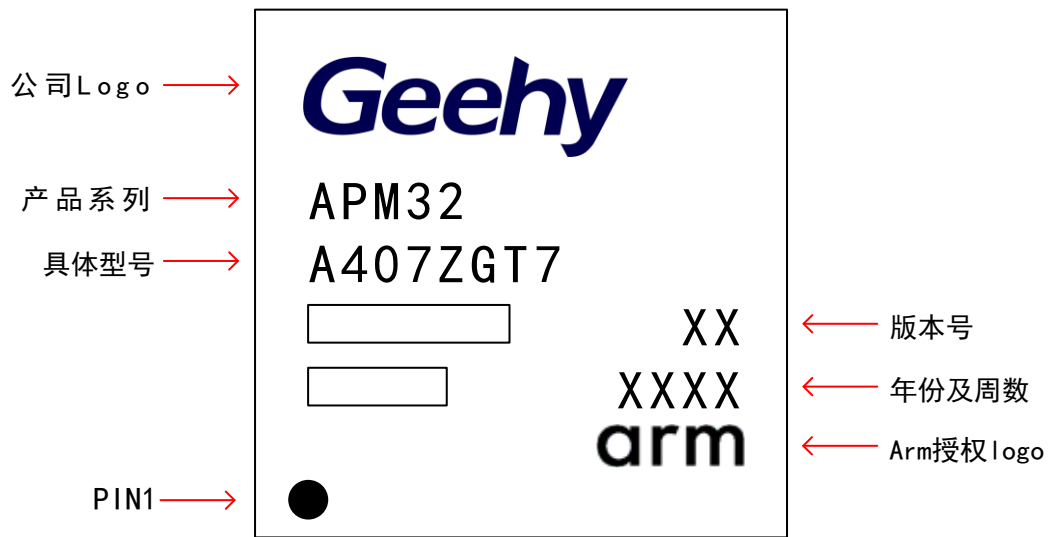
图 16 LQFP144 -144 引脚, 20 x20mm 示意图
